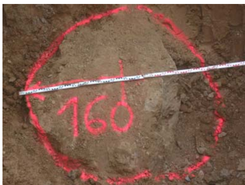
▲ Verifica Ø colonna Soilcrete
