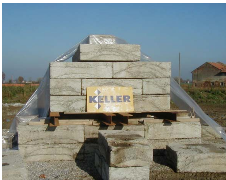
▲ Esecuzione prova di carico
