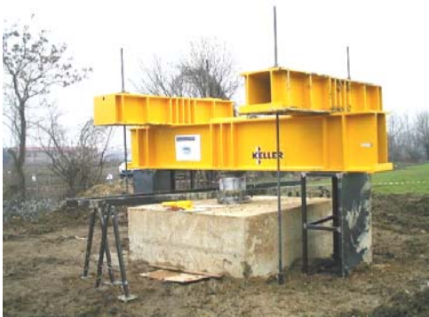
▲ Prova di carico a scala reale
